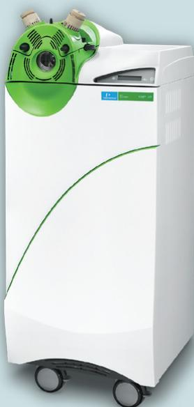
Espectrómetro de masas triple cuadrupolo Qsight 220 PerkinElmer
